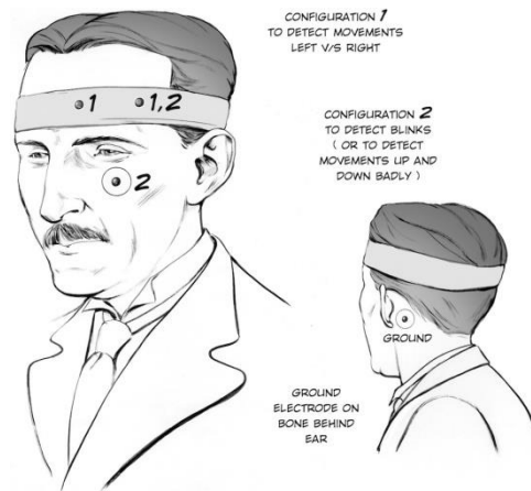
Fig. 6. Amplasarea electrozilor pentru detectarea unor expresii faciale
